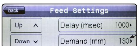
Nach dem Drücken des On Demand-Werts öffnet sich eine Nummerntastatur zum Einstellen der Ziffer. Die Ziffer muss gleich oder zwischen 30 und 400 Millimeter sein.
