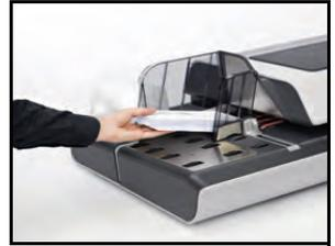
Stellen Sie sicher, dass alle Kuverts (beginnend mit den größten bis hin zu den kleinsten Kuverts) entlang der hinteren Führungsleiste aufgestapelt sind.
