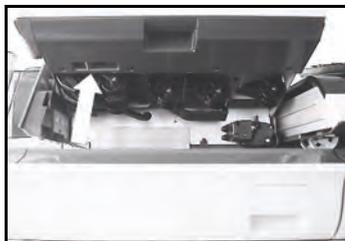
3 Schließen Sie die Abdeckung der Zuführung.
