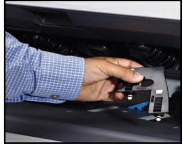
**5** Reinigen Sie die Anfeuchtrampe mit heißem Wasser.
