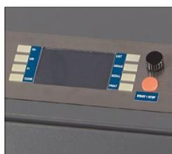
Die Bedienung kann zentral über **programmierbare Funktionstasten** am Farbdisplay und über die Touch-Screen-Einheit gesteuert werden.
