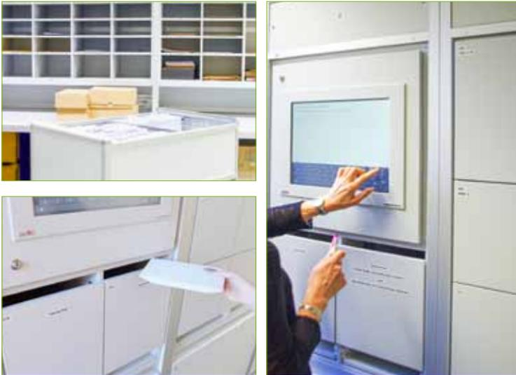
Für die Postverteilung öffnet Gänswürgers Team den rückseitigen Rollladen der Postwand und hat so Zugriff auf alle Fächer. Sobald ein Fach befüllt ist, wird der Fachinhaber elektronisch benachrichtigt. Identifiziert er sich an der Postwand mit Namen und PIN, öffnet sich sein Schließfach. Unten befindet sich die Eingangspost, oben kann Ausgangspost einlegt werden.
